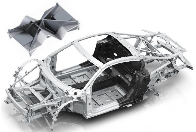
Karosserie eines modernen Automobils in Metallhybridbauweise [AUDI AG]
