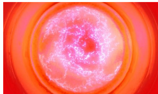
Brennfleck-Plasma beim Arc-PVD-Verfahren [hauzertechnocoating.com]
