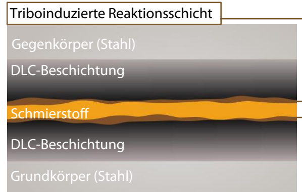
Schematische Darstellung triboinduzierter Reaktionsschichten im DLC/DLC-Kontakt
