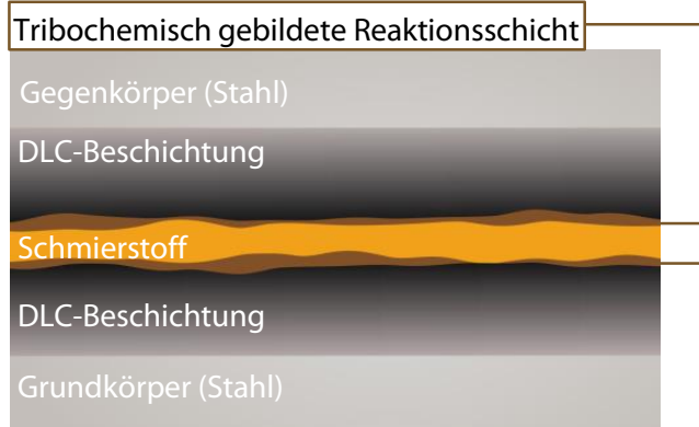
Schematische Darstellung tribochemisch gebildeter Reaktionsschichten im DLC/DLC-Kontakt
